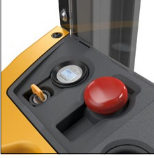
Kontrol enstrümanlarının merkezi düzeni
